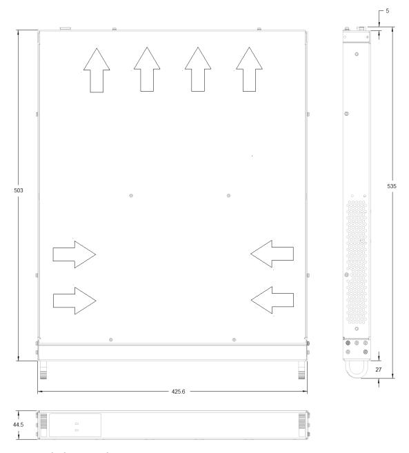
**Power Dissipator Unit**
